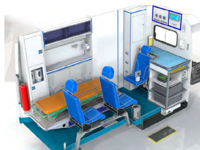
Conception avec armoires supplémentaires entre la couchette du patient et la paroi latérale du véhicule
